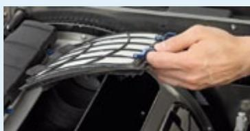
▲ Leicht entnehmbare Siebelemente (auch in 150 µm erhältlich, Art.Nr. 0871.201; Fr. 289.00) und eine Freilauffunktion ermöglichen einfachen Zugang zur Trommel.
